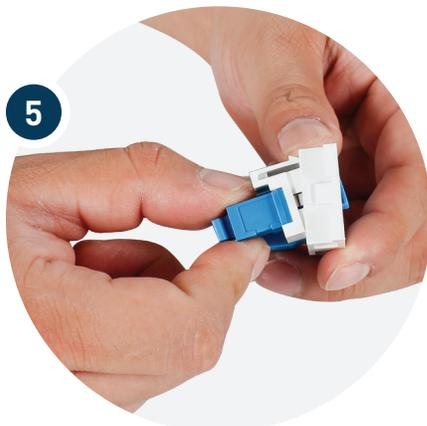
Para la instalación del módulo snap-in con acoplador simplex SC o LC. El procedimiento es el mismo que el del jack.
